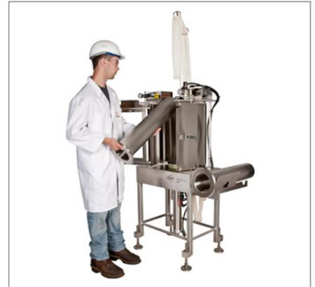
Das leere Rohr wird in der Raffmaschine platziert, an der Hebeplatte angebracht und mit dem Sicherungshebel fixiert.
