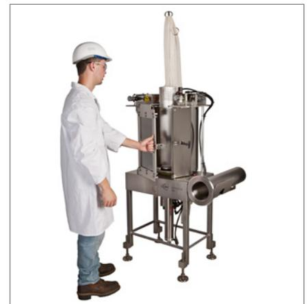
Sobald die Zugangstür vollständig geschlossen ist, kann die Maschine gestartet werden
