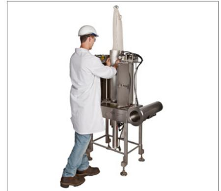
Netze/Därme werden über die Greifer (bzw. bei einigen Modellen über Drehscheiben) auf das Rohr aufgezogen.
