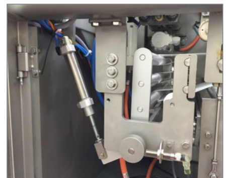
Die Tänzerrolle erhält eine konsistente Spannung aufrecht.
