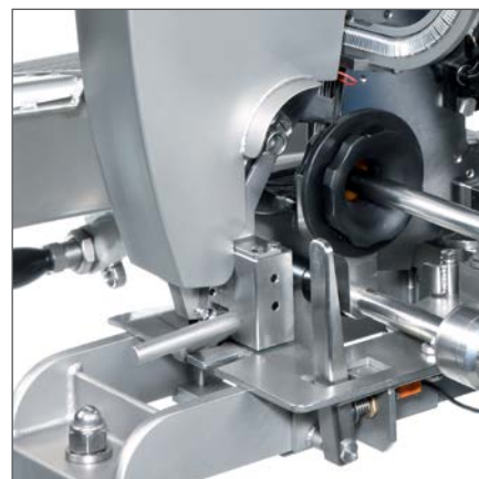
Mando con palanca palpadora para porciones ópticamente del mismo tamaño
