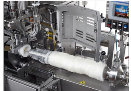
El diseño es de fácil acceso, lo que permite un cambio de la tripa rápido y sencillo. Etapa 1: abierto.
