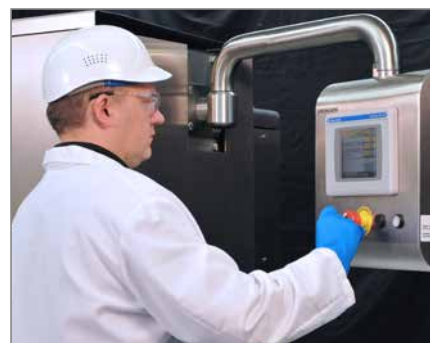
Выталкиватель с регулировкой скорости и давления в зависимости от требований к продукту.
