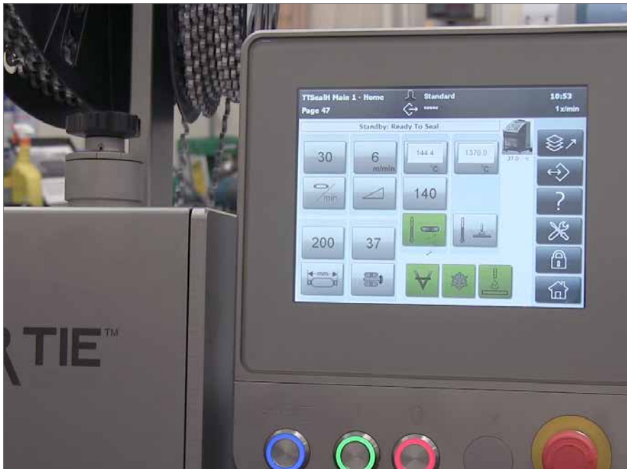
Commandes à un point pour un accès facile aux processus de scellage et de clippage
