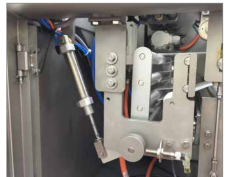
Un tendeur de film maintient une tension constante.
